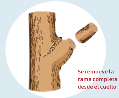
Figura 26: Corte de remoción de rama.
