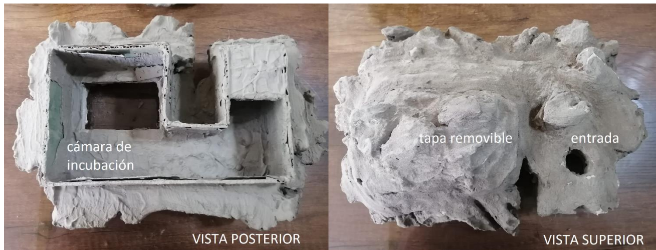
Figura 4-22 Maqueta del modelo A (Herradura) a menor escala. El hormigón se puede moldear para imitar la estructura de las costras salinas.
